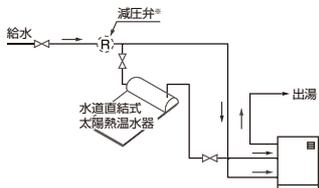
※減圧弁は、0.25MPaの減圧弁を使用してください。
